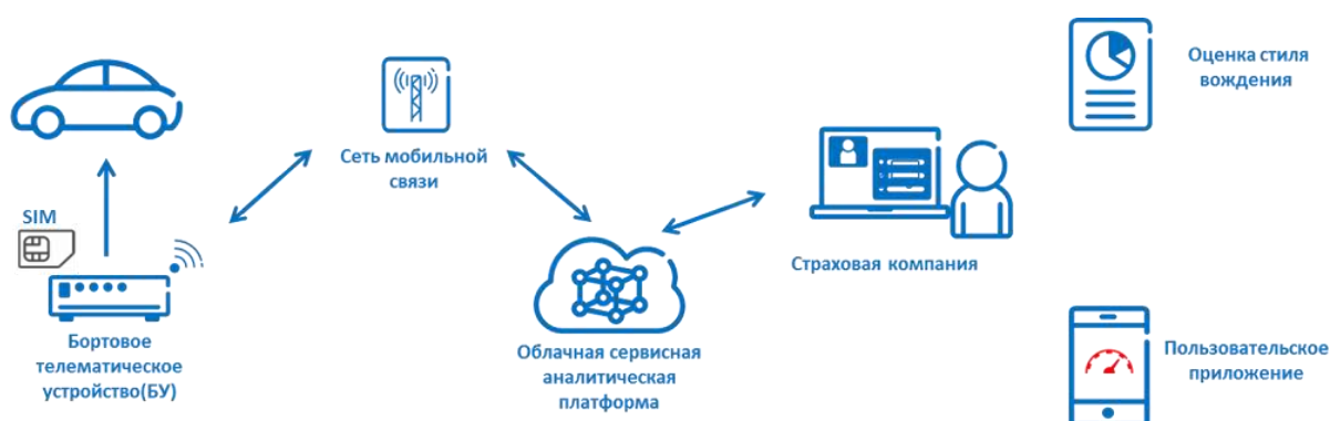
Рисунок 1- Схема осуществления «умного» страхования
