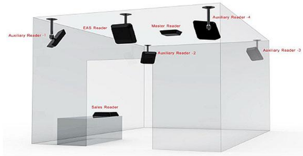
Рисунок 1. Принцип работы акустимагнитных противокражных систем
